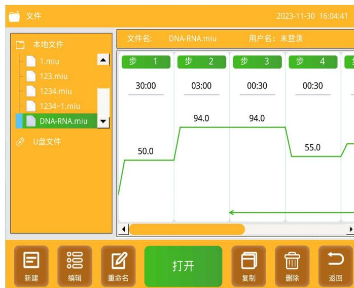
②新建文件：点击“新建”/“编辑”按键，进入新建/编辑界面。下图为包含了所有参数的温度步。温度包含的参数有温度、时间、温增、时增、梯度、速率。点击参数会弹出数字键盘，用户可以输入参数。点击“+温度”按键、“+循环”按键即可添加温度步和循环步。(注意：步骤最多可达 30 个，最大可二级嵌套)。
