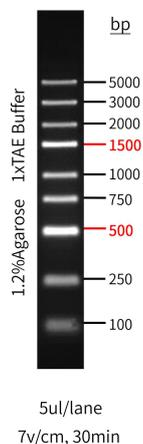
图 1 GoldBand 5,000 DNA Marker 电泳条带图
